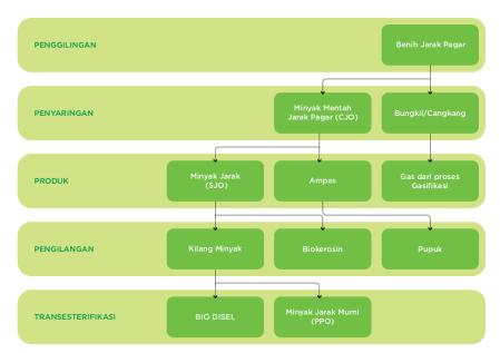
Gambar 2. Proses Pengolahan Biji Jarak Menjadi Biodiesel (Sumber: PNPM Mandiri, 2011)
